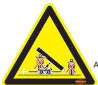
Abb. 3: Aufkleber Aufenthalt unter angehobener Ladefläche verboten
